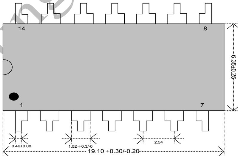
SOP14 引脚封装尺寸:
